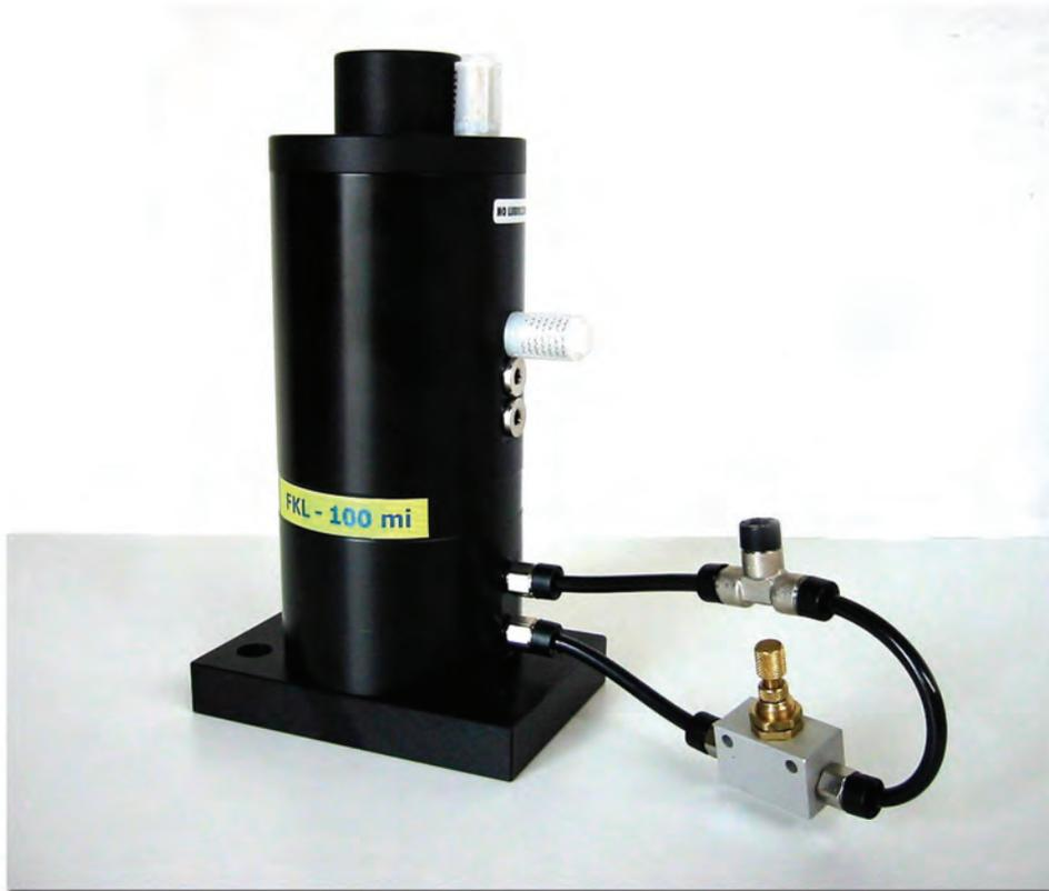
Mit Hilfe einer mitgelieferten Drossel kann der Schlagtakt des Klopfers von 1 Schlag alle 2 Minuten bis zu 200 Schläge pro Minute ohne zusätzliche pneumatische oder elektrische Steuerung eingestellt werden. Es ist lediglich ein Druckluftanschluß mit gefilterter Luft < 5µm nötig sowie ein Ventil, um den Intervallklopfer auszuschalten.
