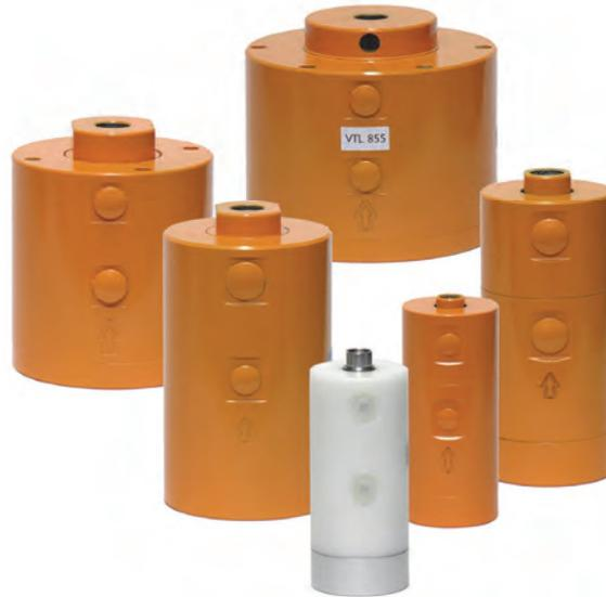
Die Kolbenvibratoren der VTL- Serie zeichnen sich durch einen freifliegenden Kolben aus, d.h. der Kolben tritt mit einer Stange aus dem Vibratorgehäuse aus. Werden die gegeneinander schwingenden Maschinen-/Gerätegruppen zum einen am Vibratorgehäuse (Boden) und zum anderen an der Kolbenstange befestigt, erzeugt der Kolbenhub eine besonders große Amplitude mit linearer Schwingung.
