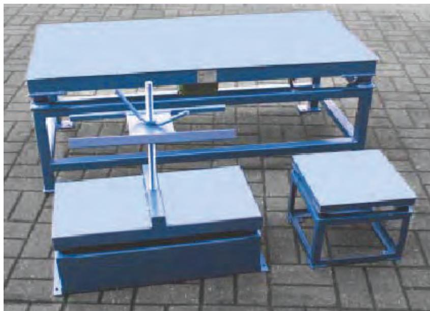
Die FTT und TCT Vibrationstische können in individuellen Größen angeboten werden. Standardmaße finden Sie auf der Folgeseite. Die Tischplatte liegt auf 4 Schwingungsdämpfern. Diese werden auf maximale Vibrationsdämpfung ausgelegt. Als Antrieb können pneumatische Vibratoren oder Vibrationsmotoren vorgesehen werden. Hiermit kann ein weiter Bereich von Anwendungen abgedeckt werden.
